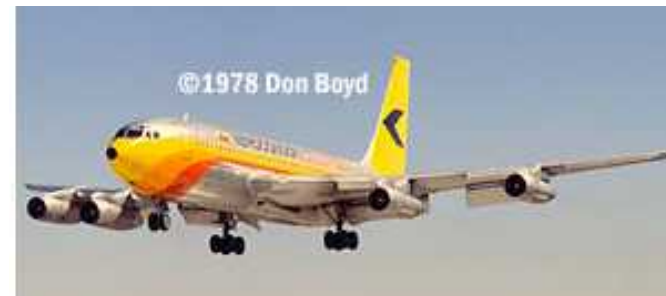
ボーイング707、そのエンジン装備法はその後のジェット旅客機の標準となった。
